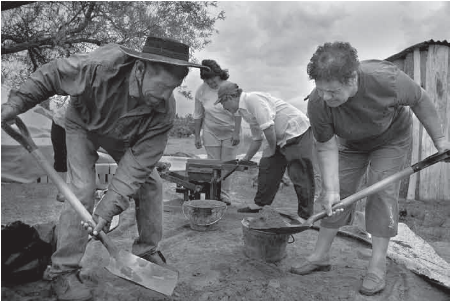
Vecinos del pueblo Zeballos trabajan en la elaboración de ladrillos prensados de arcilla. / FOTO: JAVIER CALVELO
